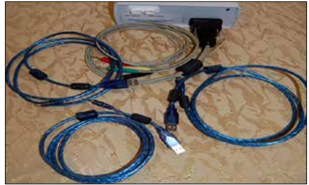
Рис. 6. Феритові фільтри на кабелях БОС
