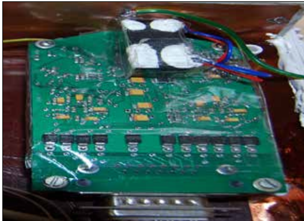
Рис. 5. Плівка ПЕТ якою вкритий модуль ЕКГ
