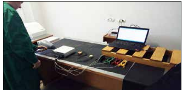
Рис. 7. Електростатичний розряд, прикладений до стінки БОС
